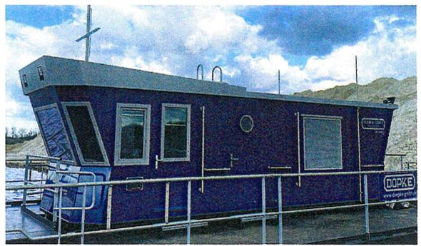
**TECHNIK-MODUL:** Die attraktive Einheit beherbergt Steuerkabine, Elektroraum, Transformatorraum und eine kleine Werkstatt.
