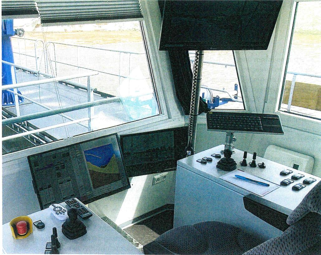
**BEDIENPULTE** mit Zwei-Achsen-Joysticks für den Verbundbetrieb von Leiter und Saugrohr (r.) sowie den Verholwindenverbundbetrieb (l.). Für die Steuerung von Land aus stehen Steuer-Controls im DredgerControl-System zur Verfügung (Bild l., unten).
